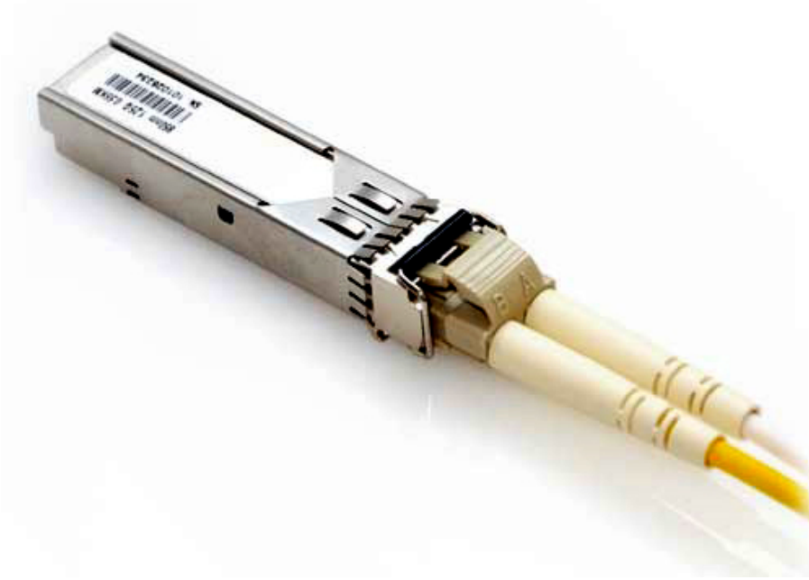
SFP med dubbelriktad fiber inkopplad.
